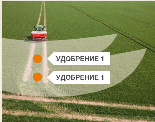
Идеальные точки отключения для различного типа удобрений.
