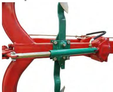
Как альтернатива пластинчатым пружинам может поставляться гидравлический цилиндр простого действия [PW].
