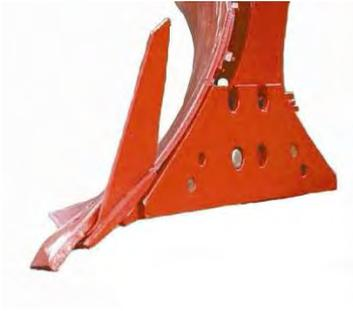
Альтернативный инструмент дисковым ножам плуга, если необходимо уменьшить вес или если вероятно засорение машины пожнивными остатками или камнями. Используются только с плугами с реверсивными режущими кромками.
