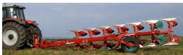
Сначала передний конец плуга поднимается на рычагах трактора. Затем постепенно задняя часть поднимается гидравлическим цилиндром на колесе копирования.
