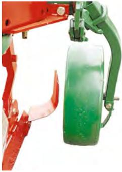
Для использования на задней секции, служит для увеличения ширины дна борозды, чтобы иметь возможность агрегатировать трактор с широкими шинами.
