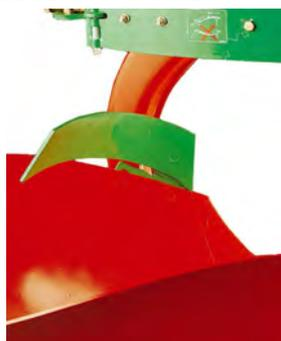
Особенно полезны, если на поверхности находится большое количество пожнивных остатков – компост, солома и т.п. Использование щитков для заделки пожнивных остатков увеличивает расстояние между секциями по сравнению с использованием предплужников.
